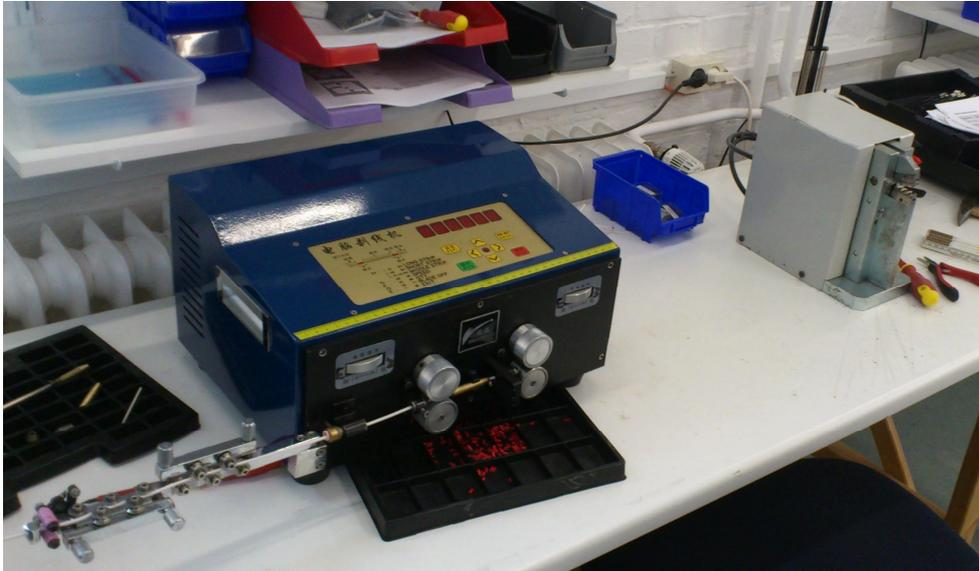
Anschaffung einer automatischen Kabelzuschnitt- und Abisoliermaschine
